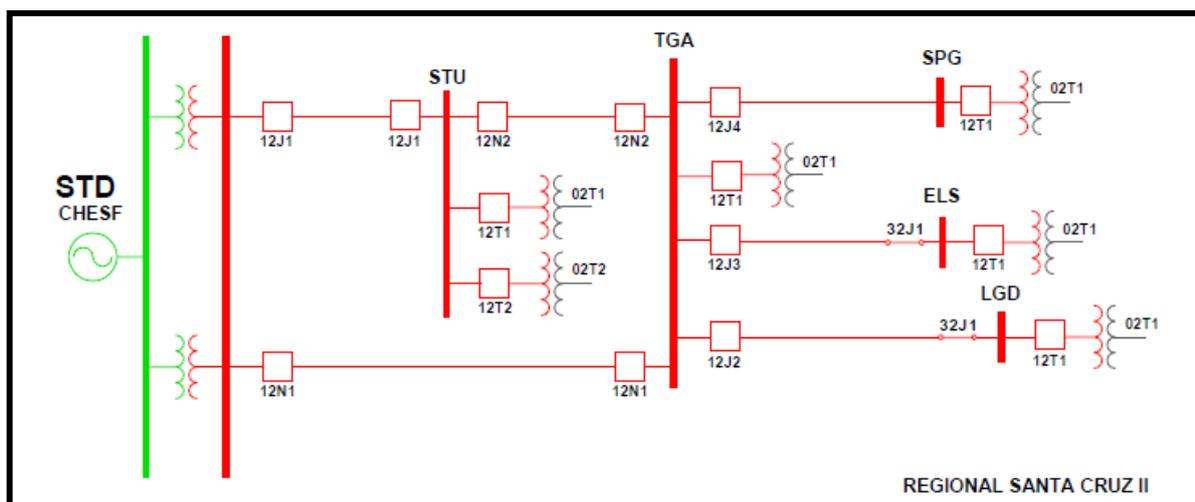
Figura 3 - Diagrama elétrico unifilar de linhas de subtransmissão do sistema elétrico do Estado do Rio Grande do Norte do regional que supre o município de Ruy Barbosa.
